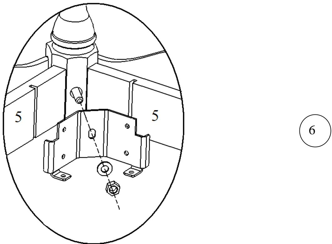
Закрепите конструкцию с помощью косынок. Установите косынку как показано на рис.6 (надев ее на шпильку так, чтобы она попала в пазы деталей №5). Наденьте шайбу на шпильку и заверните гайку (не полностью). Во все отверстия косынки вверните саморезы 3,5x16. Заверните гайку до упора.
