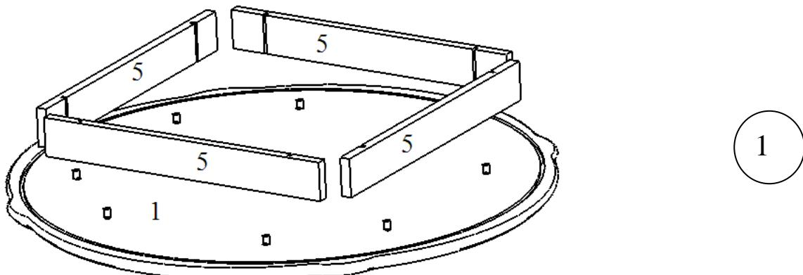
Вставьте в деталь №1 шканты в отверстия Ø8мм. Установите детали №5 на деталь №1.
