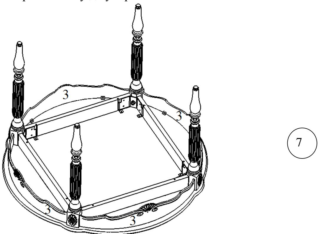
Детали №3 закрепите с помощью уголков для усиления задней стенки.
