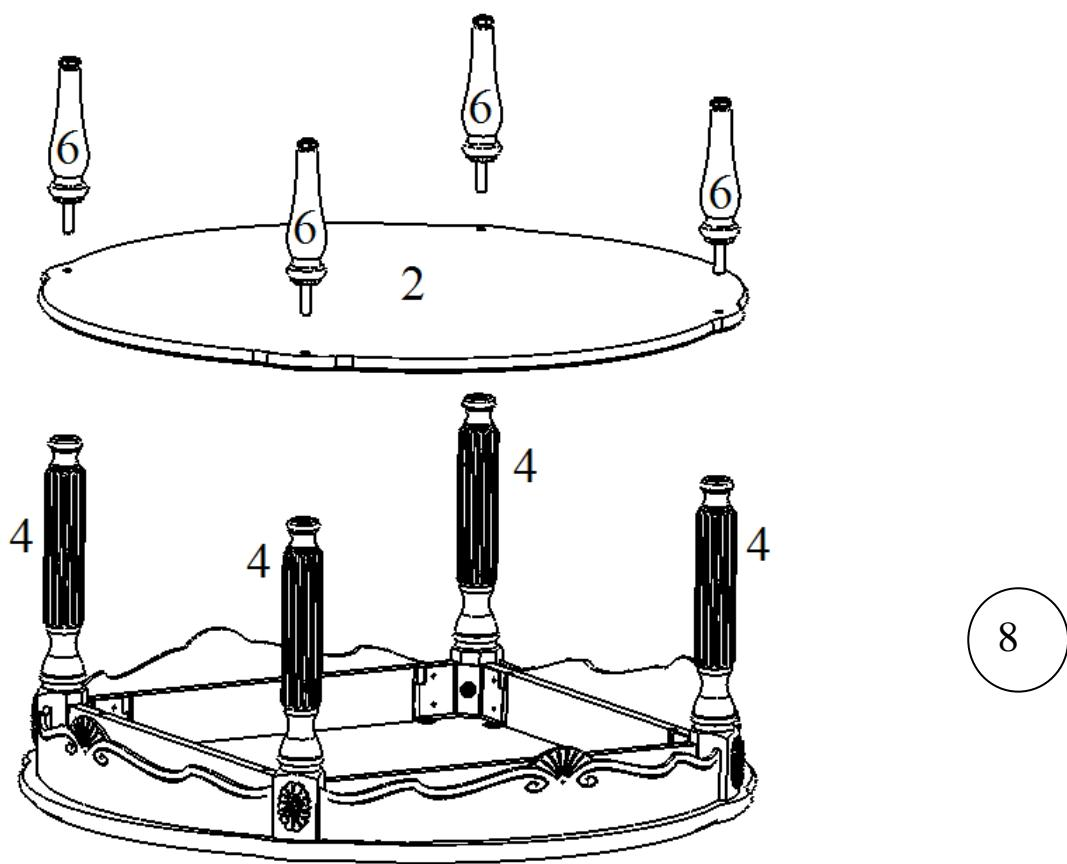
Вкрутите детали №6 в детали №4 через деталь №2 на шпильку-саморез до упора (не перетягивать!).
