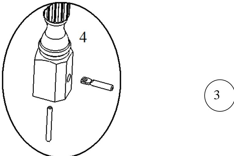
Вставьте шпильку в боковое отверстие ноги №4. В нижнее отверстие ноги №4 вставьте штифт так, чтобы он попал в отверстие в шпильке (рис.3).
