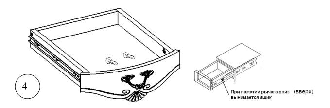
Винтами М4х20 установите ручку на фасад ящика (при необходимости используйте подкладки под винт) рис.4.
