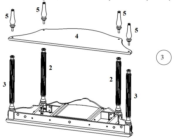
Вкрутите детали №5 в детали №2 и №3 через деталь №4 на шпилькусаморез до упора (не перетягивать!).
