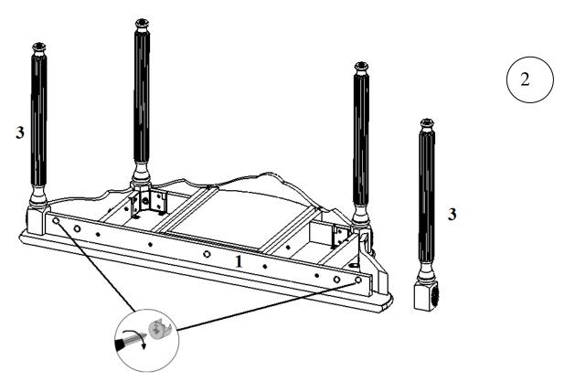
Вставьте в детали №3 шканты в отверстия Ø8 мм и вкрутите штоки в отверстия Ø5 мм. В деталь №1 вставьте эксцентрики. Установите детали №3 на деталь №1 (рис 2). В деталь №1 заверните эксцентрики до упора.
