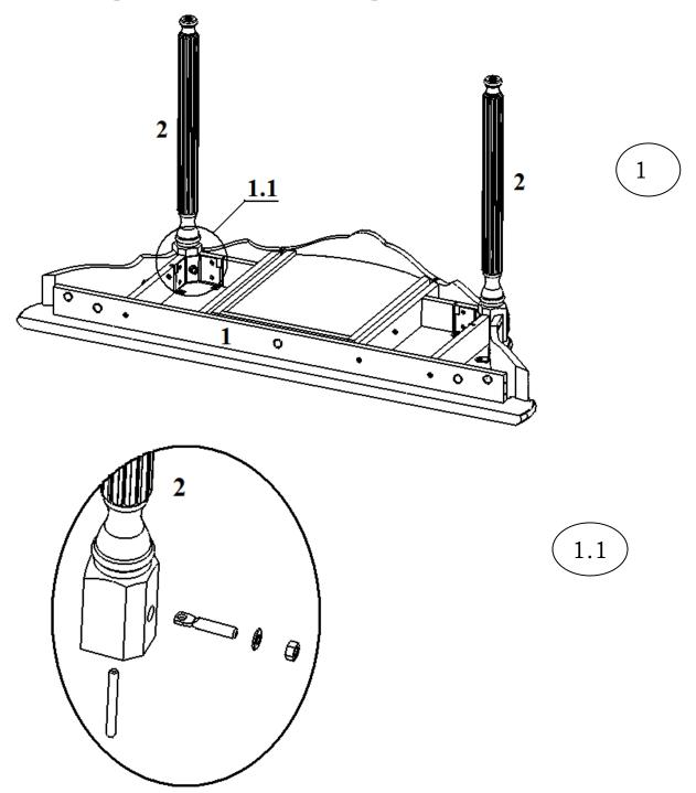
Вставьте шпильку в боковое отверстие ноги №2. В нижнее отверстие ноги №2 вставьте штифт так, чтобы он попал в отверстие в шпильке (рис.1.1). Придерживая штифт вставьте шпильку в отверстие в косынке. Наденьте шайбу на шпильку и заверните гайку (рис.1.1).
