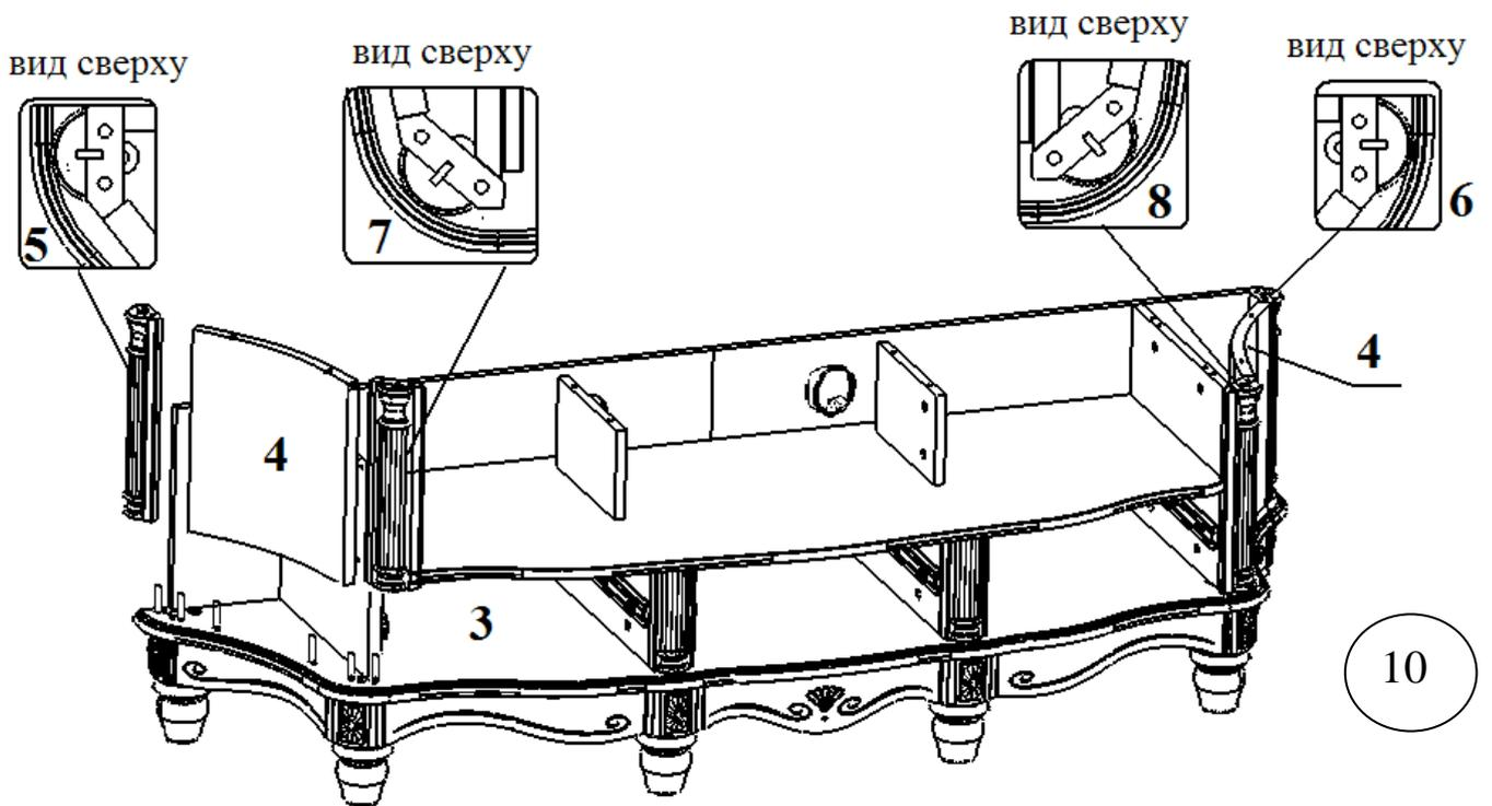
Вставьте в деталь №3 шканты в отверстия  $\text{Ø}8$  мм. Установите детали №4, №5, №6, №7, №8 на подсобранную конструкцию.
