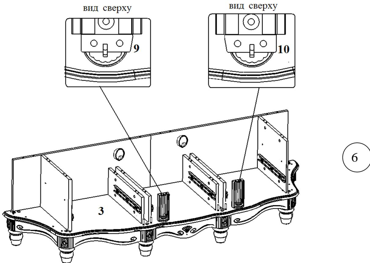
Вставьте в деталь №3 шканты в отверстия Ø8мм. Установите детали №9, №10 на деталь №3 (рис 6).
