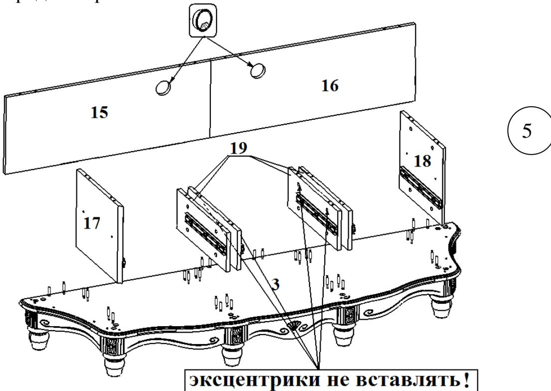
Вставьте в деталь №3 шканты в отверстия Ø8 мм и вкрутите штоки в отверстия Ø5 мм. В детали №15, №16, №17, №18 вставьте эксцентрики. В детали №19 вставьте эксцентрики как показано на рис. 5 – в детали, расположенные в центре, эксцентрики вставить только снизу. Установите детали №15, №16, №17, №18 и №19 на деталь №3 (рис 5). В детали №15, №16, №17, №18 и №19 заверните эксцентрики до упора. В детали №15 и №16 вставьте заглушки (рис.5).
