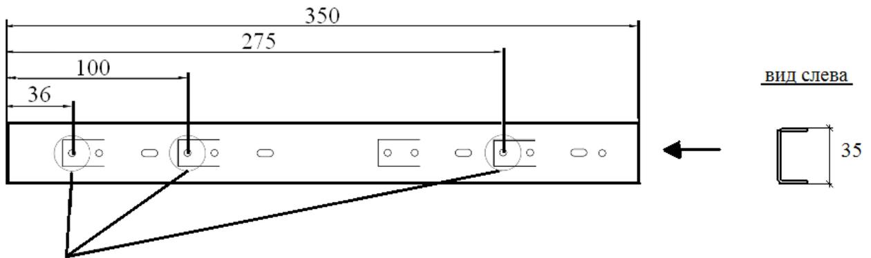
Монтажные отверстия, используемые для крепежа
