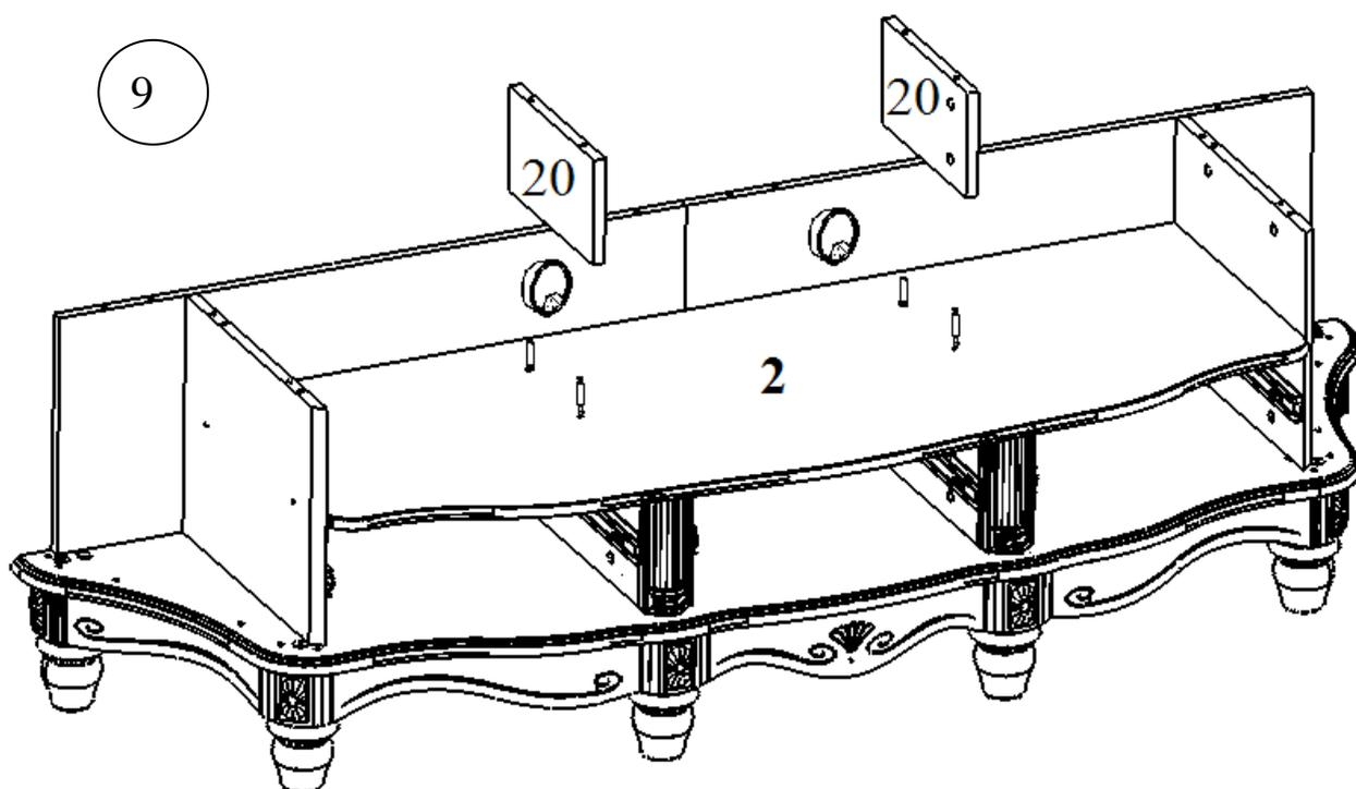
Вставьте в деталь №2 шканты в отверстия  $\text{Ø}8$  мм и вкрутите штоки в отверстия  $\text{Ø}5$  мм. В детали №20 вставьте эксцентрики. Установите детали №20 на подсобранную конструкцию. В детали №20 заверните эксцентрики до упора (рис. 9).
