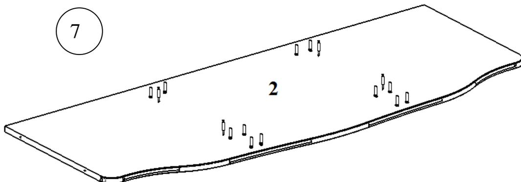
Вставьте в деталь №2 шканты в отверстия Ø8 мм и вкрутите штоки в отверстия Ø5 мм (рис. 7).
