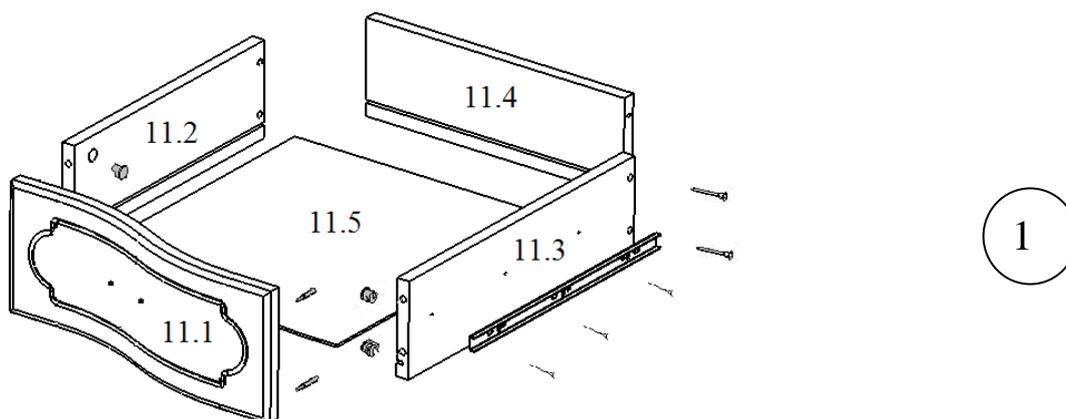
В детали №11.2 и №11.3 вставьте эксцентрики. Боковины ящика №11.2 и №11.3 соедините со стенкой №11.4 на конфирматы. Дно ящика №11.5 вставьте в пазы деталей №11.2, №11.4, №11.3. Вкрутите в фасад ящика №11.1 штоки эксцентрика, и соедините фасад с боковыми стенками №11.2 и №11.3. В детали №11.2 и №11.3 заверните эксцентрики до упора (рис. 1).
