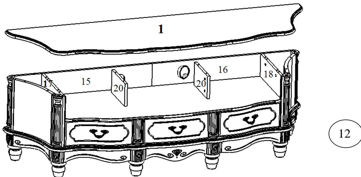
Установите деталь №1 на подсобранную конструкцию. В детали №15, №16, №17, №18, №20 заверните эксцентрики до упора (рис. 12).
