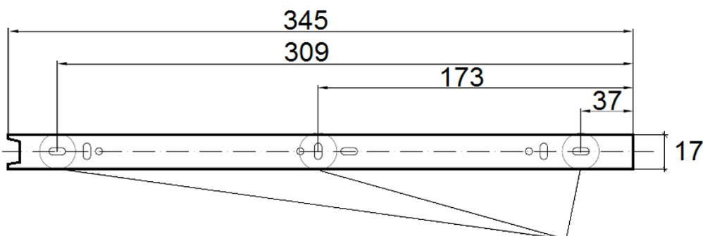
Монтажные отверстия, используемые для крепежа
