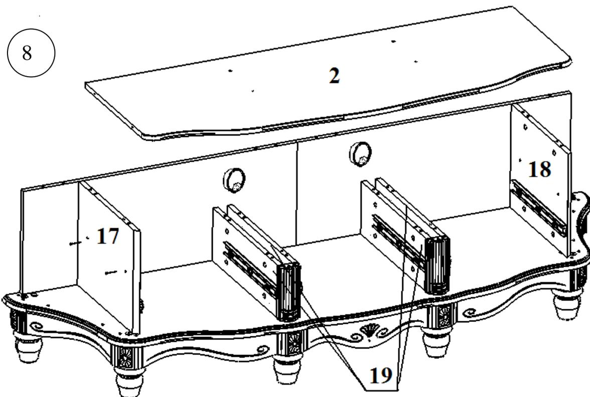
Установите деталь №2 на подсобранную конструкцию. В детали №19 заверните эксцентрики до упора. Детали №17 и №18 соедините с деталью №2 конфирматами (рис 8).
