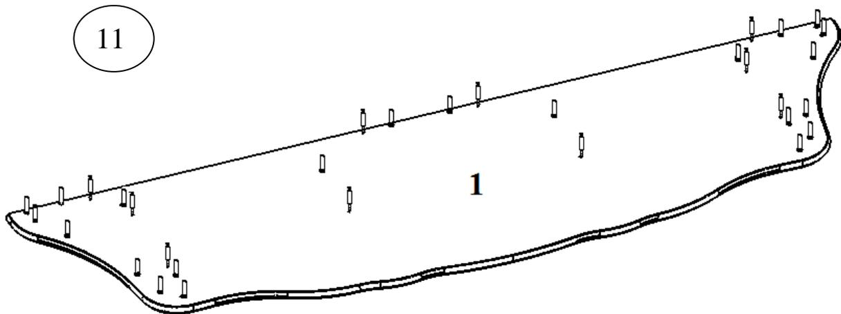
Вставьте в деталь №1 шканты в отверстия  $\text{Ø}8$  мм и вкрутите штоки в отверстия  $\text{Ø}5$  мм (рис. 11).
