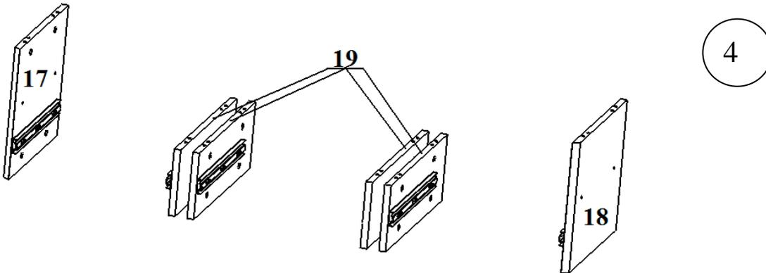
Прикрутите ответные части шариковых направляющих на детали №17, №19 и №18 (рис.4) согласно насечкам в 3 отверстия с помощью саморезов 3,5x16. При правильной установке ответные части направляющих должны быть расположены на деталях №19 заподлицо с передней кромкой.
