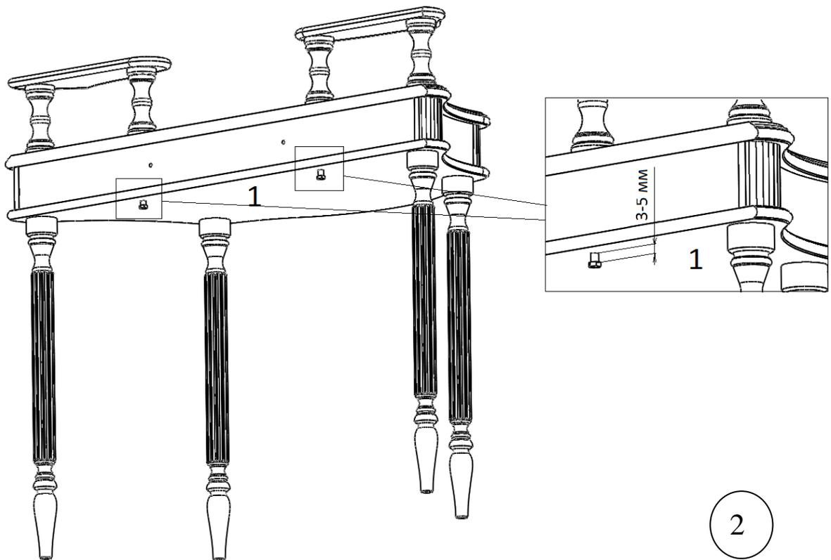
Из сборочной единицы №1 снизу вывернуть шурупы 8x80 на высоту 3-5 мм как показано на рис. 2
