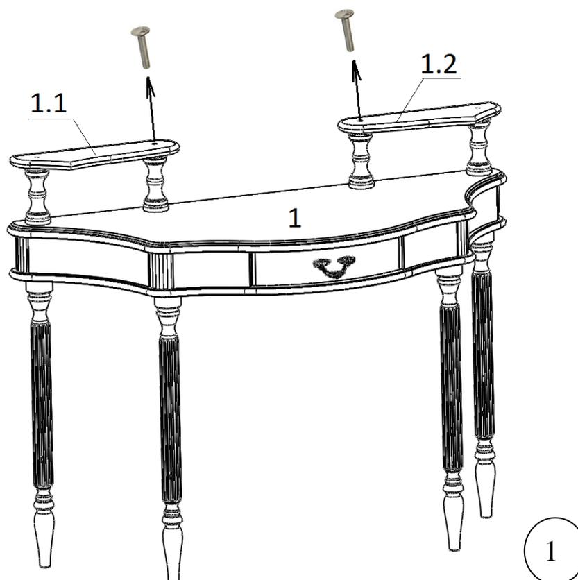
Выкрутить винты М8х45 из деталей № 1.1 и №1.2 как показано на рис. 1.
