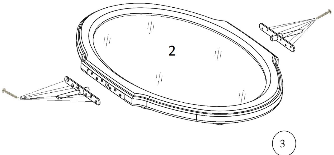
Прикрутите оси на деталь №2 с помощью саморезов 3,5x16 мм как показано на рис. 3.
