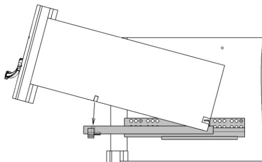
Вставьте ящики. Для этого выдвиньте направляющие вперёд, вставьте ящик так, чтобы крючок направляющей попал в отверстие задней стенки ящика, опустите ящик вниз, штырь направляющей должен попасть в отверстие боковой стенки ящика (рис.19).
