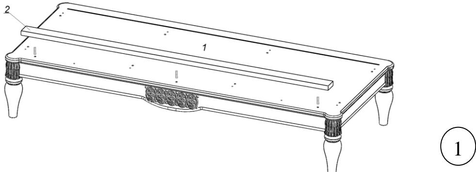
Соедините детали №1 и №2 с помощью шкантов 8x30 (рис.1)
