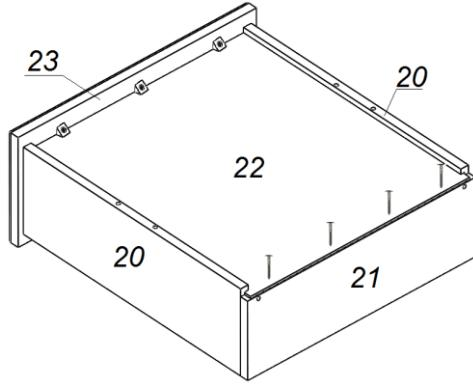
Дно ящика №22 вставьте в пазы деталей №20 и №23. Прибейте деталь №22 гвоздями 1,2x25 мм к детали №21 (рис. 18). Закрепите дно ящика и фасад уголками.
