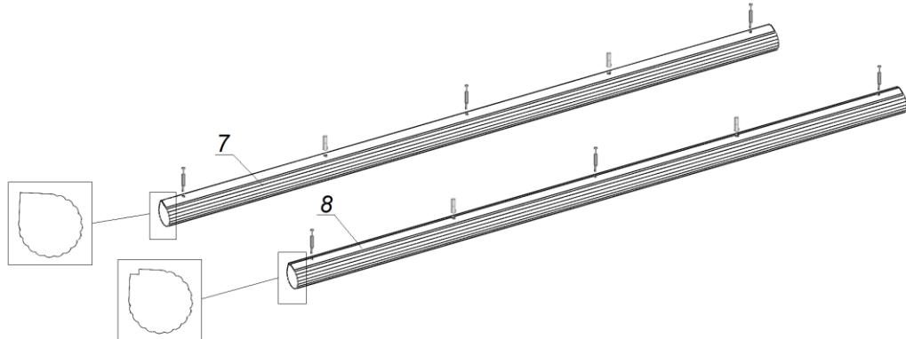
В колонны №7 и №8 вкрутите штоки эксцентриков в отверстия Ø5 мм, в отверстия Ø8 мм вставьте шканты 8x30 мм. (рис. 10)
