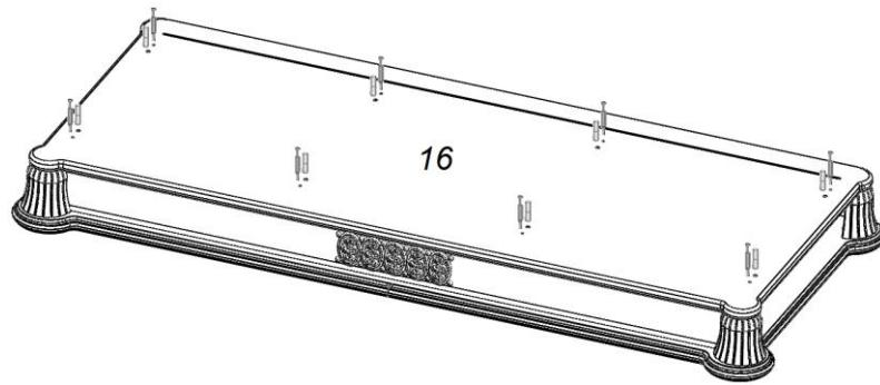
Подготовьте к сборке карниз: в отверстия Ø5 мм вкрутите штоки эксцентриков и вставьте шканты 8x30 мм в отверстия Ø8 мм (рис. 9).
