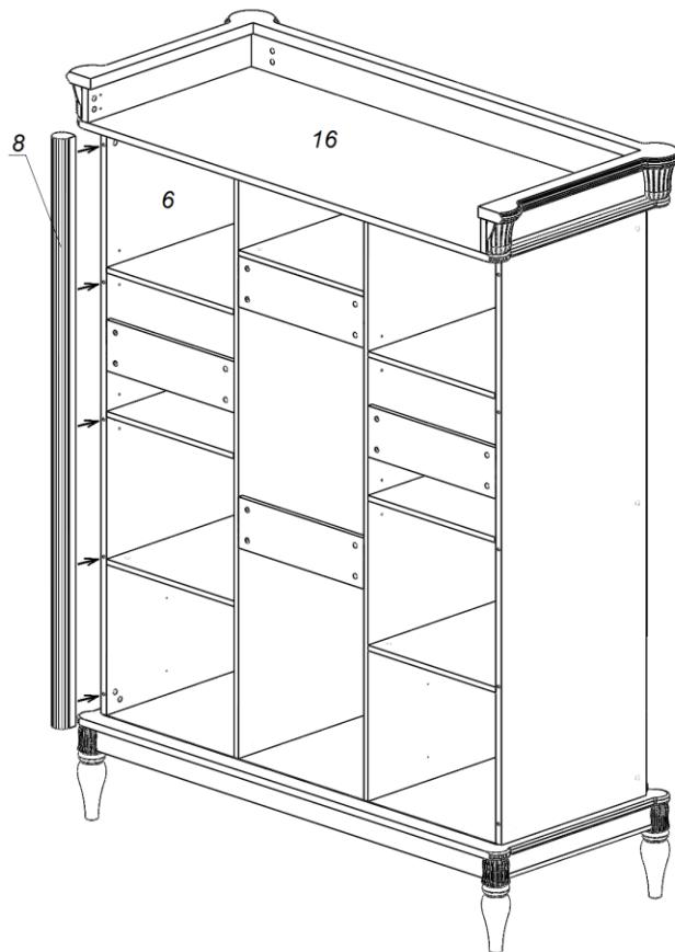
Установите карниз, не заворачивая эксцентрики. Далее к детали №6 присоедините колонну №8 (колонна с пазом), заверните до упора эксцентрики в детали №6 (рис.11).
