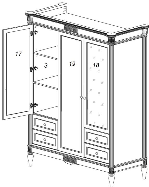
Саморезом 3,5x16 мм закрепите срединные петли на дверь №19 и вкладные петли на двери №17 и №18 и №19. Установите двери на монтажные планки (рис. 20). Отрегулируйте двери (рис.22). Винтами M4x28 мм установите ручки на двери, при необходимости используя подкладки под винт.
