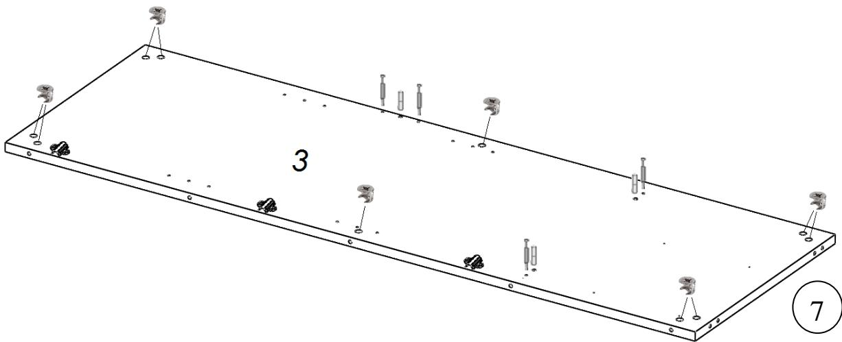
К детали №3 прикрепите ответные планки петель D3 саморезами 3,5x16. В отверстия Ø15 мм вставьте эксцентрики (для плит 22 мм), в отверстия Ø8 мм вставьте шканты 8x30 мм и вкрутите штоки эксцентриков в отверстия Ø5 мм (кроме отверстий под полкодержатели). Аналогично подготовьте к сборке деталь №6 (рис. 7).
