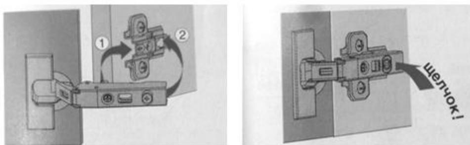
Процесс монтажа двери выполняется сверху вниз. Петля спереди накладывается на монтажную планку (поз.1), затем консоль петли защелкивается на монтажной планке (поз. 2) легким нажатием.
