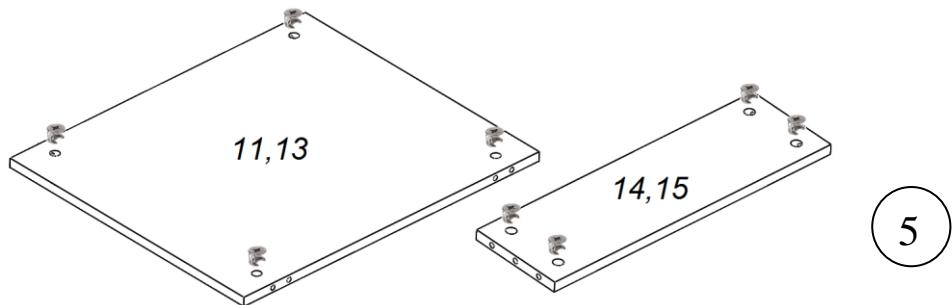
В детали №11, №13 и №14,15 вставьте эксцентрики (для плит 16 мм) в отверстия Ø15 мм (рис. 5).
