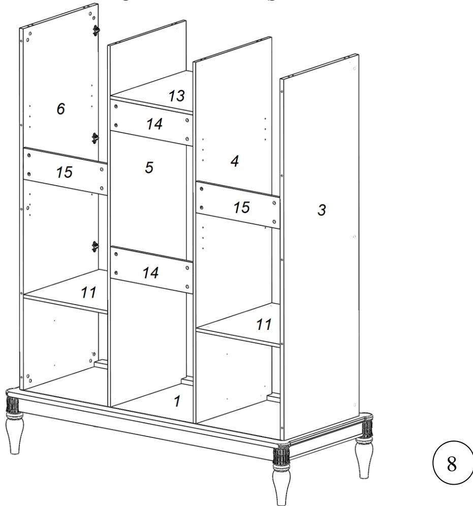
Присоедините детали №15 и №11 к детали №4, заверните в деталях №11 и №15 эксцентрики до упора. Придерживая детали №11 и №15, присоедините вертикальную стенку №3. Заверните эксцентрики до упора в деталях №11, №15 и №3 до упора (рис. 8), аналогично присоедините детали №6, №11 и №15 с другой стороны изделия, заверните эксцентрики до упора в деталях №6, №11 и №15.
