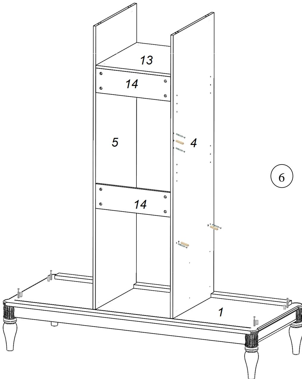
Установите на цоколь деталь №4, затем, придерживая ее, присоедините к ней детали №13 и №14, закрутив эксцентрики в них до упора. Далее придерживая подсобранные детали присоедините деталь №5 (рис. 6). Заверните до упора эксцентрики в деталях №4, №5, 13 и №14. В детали №4 и №5 в отверстия Ø8 мм вставьте шканты 8x30 мм и вкрутите штоки эксцентриков в отверстия Ø5 мм (кроме отверстий под полкодержатели),
