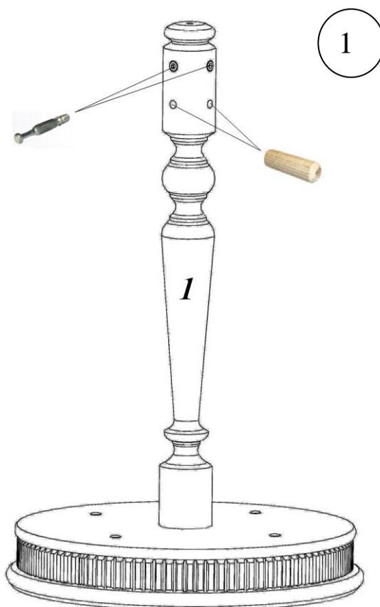
Деталь №1 (узел в сборе) расположите лицевой стороной вниз. В отверстия с футорками вкрутите штоки эксцентров, в отверстия Ø10мм вставьте шканты (рис. 1).
