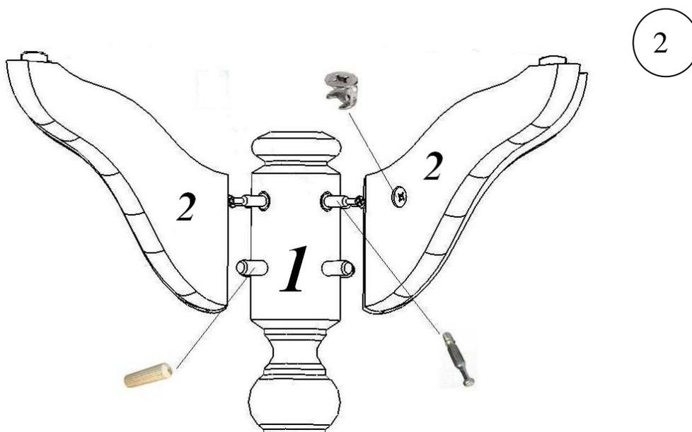
В детали №2 вставьте эксцентрики. Установите детали №2 на деталь №1 (узел в сборе) и заверните в них эксцентрики до упора (рис. 2).
