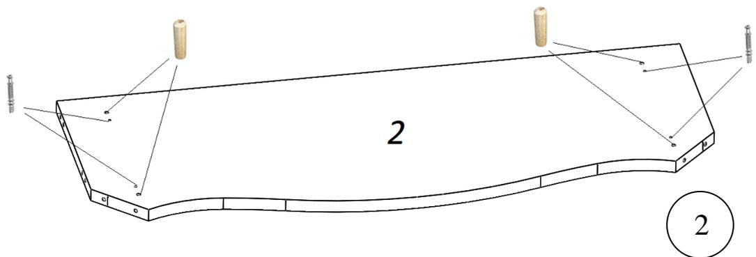
Вставьте шканты в отверстия Ø8 мм, вкрутите штоки в отверстия Ø5 мм (рис.2).
