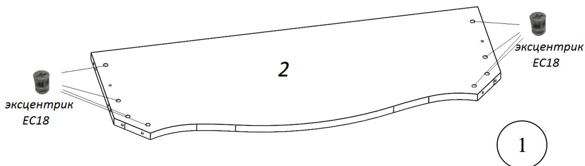
В деталь №2 установите эксцентрики EC18 в отверстия Ø15 мм (рис.1) и переверните деталь.
