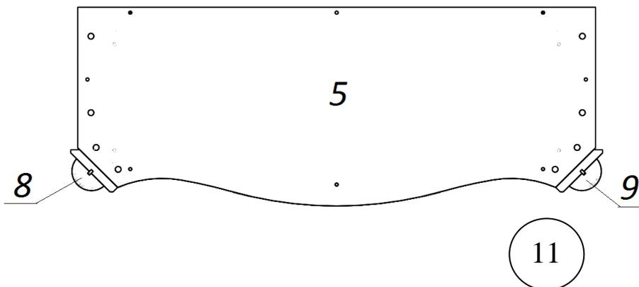
Колонны №8 и №9 соедините с деталями №2 и №5. В деталях №2 и №5 заверните эксцентрики до упора (рис. 10 и 11).
