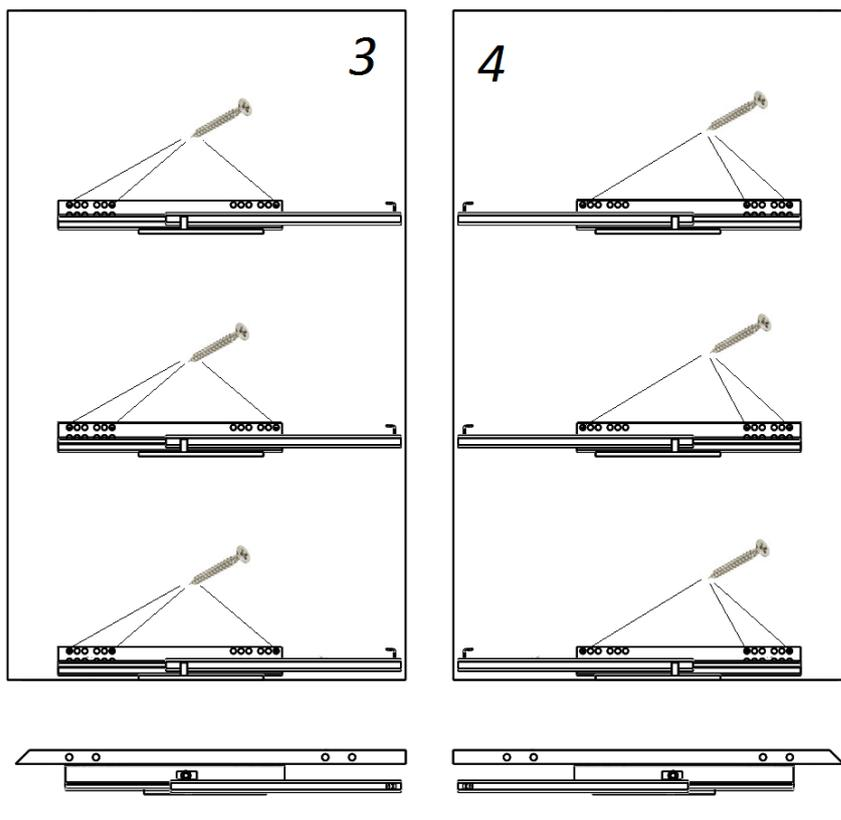
С обратных сторон деталей №3 и №4 установите направляющие Quadro 400 через отверстия, указанные на рис. 4, саморезами 3,5x16 по наконкам.
