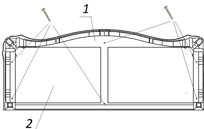
Закрепите детали №1 и №2 саморезами 4x41 через отверстия в цоколе 1. (рис.17).
