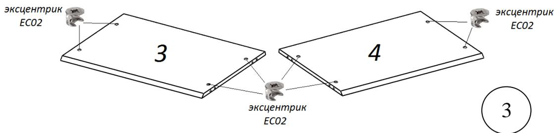
В детали № 3 и № 4 в отверстия Ø15 мм установите эксцентрики EC02 (рис. 3).
