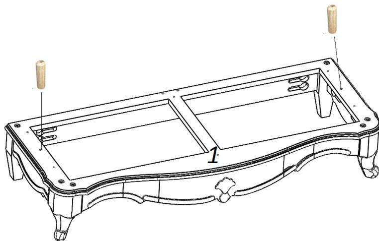
В деталь №1 вставьте шканты в отверстия Ø8 мм, (рис.15).
