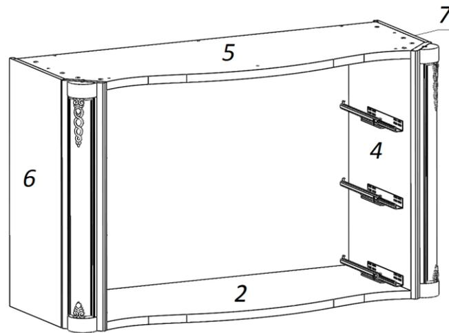
Детали №6 и №7 соедините с деталями №2 и №5. В деталях №2 и №5 заверните эксцентрики до упора (рис. 13). Расположение деталей в зависимости от узора указано на рис. 14.
