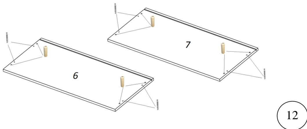
В детали №6 и №7 вставьте шканты в отверстия Ø8 мм, вкрутите штоки в отверстия Ø5 мм (рис.12).
