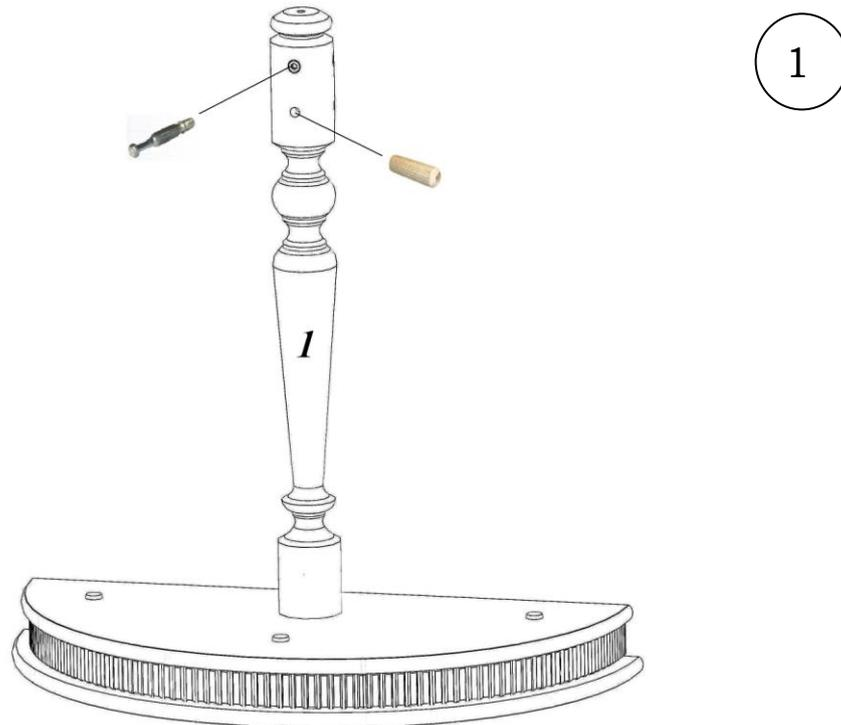
Деталь №1 (узел в сборе) расположите лицевой стороной вниз. В отверстия с футорками вкрутите штоки эксцентров, в отверстия Ø10мм вставьте шканты (рис. 1).
