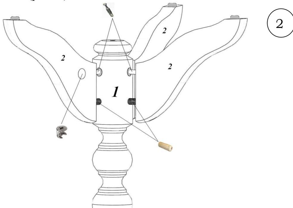
В детали №2 вставьте эксцентрики. Установите детали №2 на деталь №1 (узел в сборе) и заверните в них эксцентрики до упора (рис. 2).
