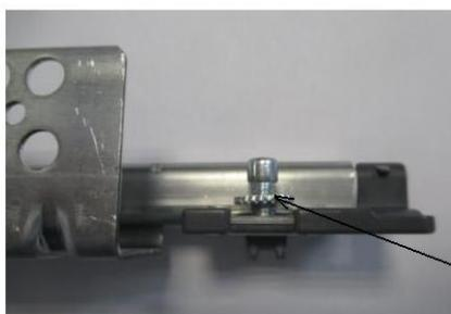
гайка для регулировки
