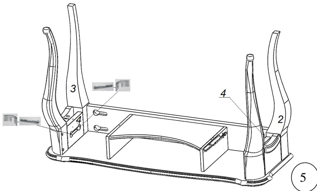
Детали №4 соедините с подсобранной конструкцией с помощью шайбы полукруглой и винта  $8 \times 60$  (рис. 5).
