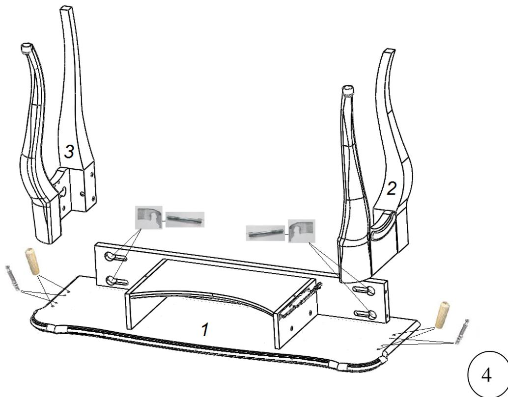
В детали №1, в отверстия  $\text{Ø}5$  мм вкрутите штоки эксцентриков, в отверстие  $\text{Ø}8$  мм вставьте шканты  $8 \times 30$ . Соедините опоры №2 и №3 с верхом №1 с помощью шайбы полукруглой и винта  $8 \times 60$  и эксцентриковой стяжки, в опорах №2 и №3 заверните эксцентрики до упора (рис. 4).
