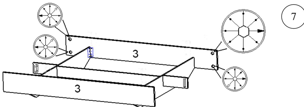
В детали №3 в отверстия  $\text{Ø}35$  вставьте эксцентрики (рис.7).
