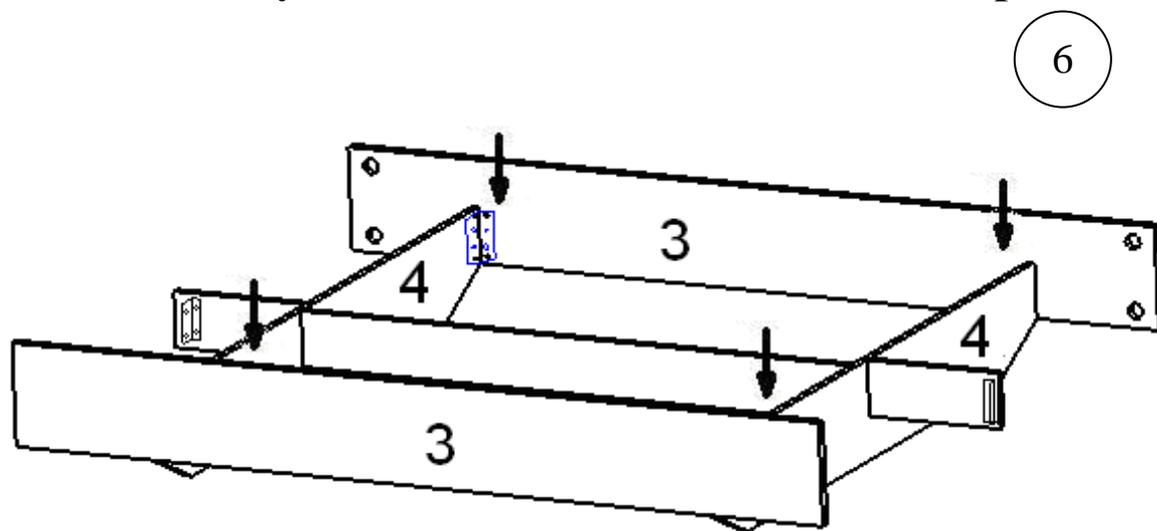
К деталям №4 присоедините детали №3, закрепив уголки с помощью винтов М6х10 и саморезов 3,5х16 (рис.6).
