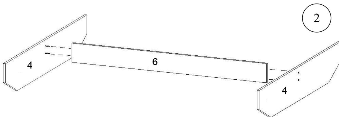
Соедините с помощью конфирматов детали №4 и №6 (рис.2).
