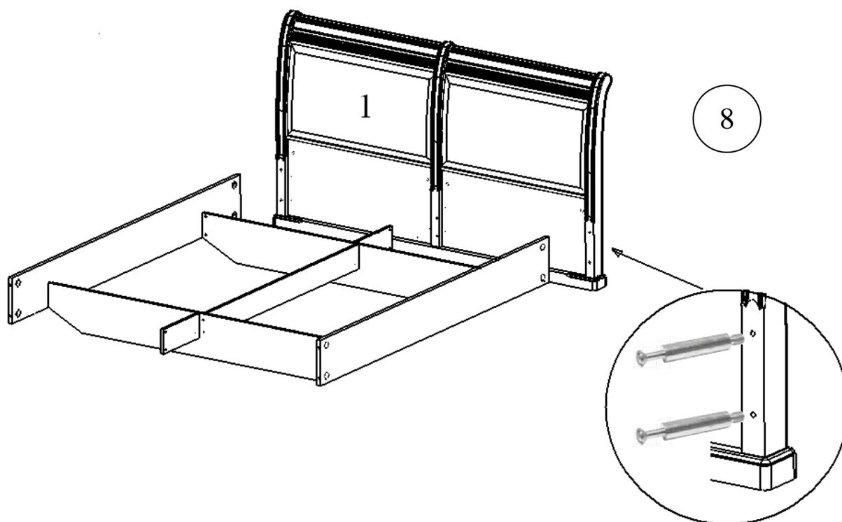
В изголовье кровати (деталь №1) вверните штоки эксцентрика (рис.8). Наденьте каркас кровати на штоки и с помощью шестигранного ключа № 6, поворачивая эксцентрики, притяните каркас к изголовью.
