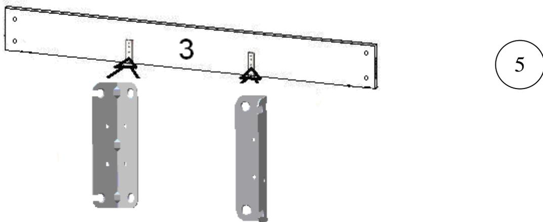
К детали №3 с помощью винтов М6х10 и саморезов 3,5х16 присоедините уголки как показано на рис.5. **Необходимо расположить уголок относительно деталей вырезом наружу.**
