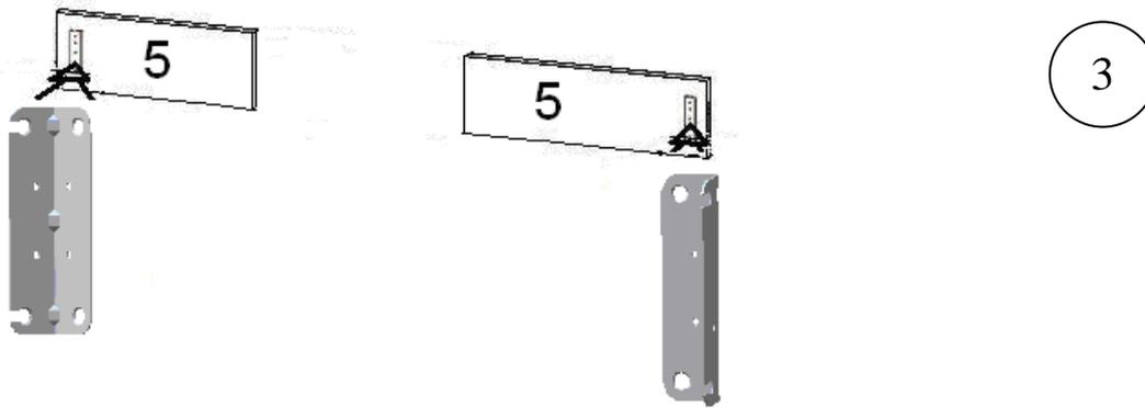
К деталям №5 с помощью винтов М6х10 и саморезов 3,5х16 присоедините уголки как показано на рис 3. **Обратите внимание на положение уголка!** Необходимо расположить уголок относительно деталей вырезом наружу.
