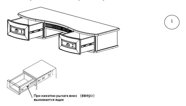
Выньте боковые ящики №1 и №2 из корпусов столешницы (рис. 1).
