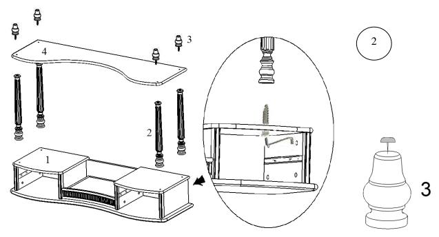
Столешницу (деталь №1) расположите лицевой стороной вниз. С внутренней стороны корпусов столешницы вставьте конфирматы. Вкрутите детали №2 в конфирмат, придерживая его шестигранным ключом как показано на рис.2 (не перетягивать!).
