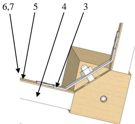
Рис. 1. Схема крепления ноги
