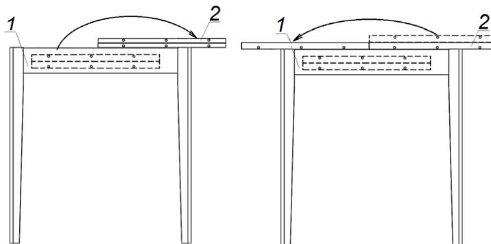
Рис.2 Установка вставки
