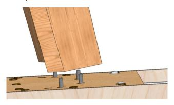
5. С помощью  $\Gamma$ -образного ключа шестигранного 6x135 (входит в комплект стола), закрутите все четыре болта M8x50 до упора, соединив ногу с опорой стола. Аналогично первой ноге, закрепите вторую ногу.
