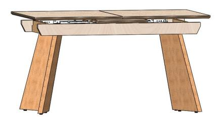
6. Переверните стол в сборе с ногами. ВНИМАНИЕ Стол переворачивать втроем или вчетвером. Поворот столешницы в сборе с подстольем, в том числе на 90° при установке на торец, осуществлять ТОЛЬКО со сложенной вставкой и ТРАНСПОРТНОЙ ПРОКЛАДКОЙ между вставкой и столешницами. Поворот столешницы без транспортной прокладки приведет к разрушению механизма трансформации стола.
