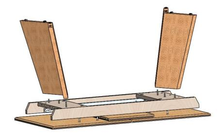
4. Взять ногу в сборе, расположить, как показано на рисунке, приложив к опоре стола. Поочередно наживить в футорки ноги 4 болта M8x50 с шайбами, предварительно продев их через отверстия в опоре стола.
