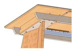
8. Установите поперечные царги на место и закрепите их, с помощью крестовой отвертки, повернув 6-ть эксцентриковых стяжек на  $90^{\,0}$  по часовой стрелке.
