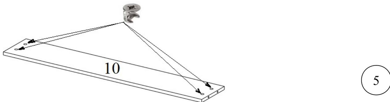
В деталь №10 в отверстия Ø15мм вставьте эксцентрики.
