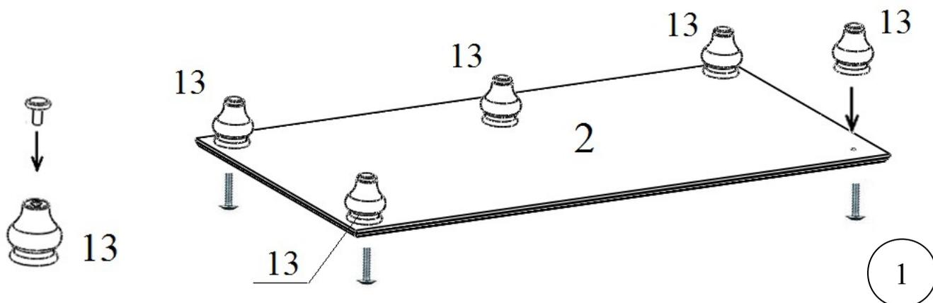
В детали №13 вверните ножки П1 03 (рис.1). Соедините ноги №13 с деталью №2 винтами М8х30 (рис 1).
