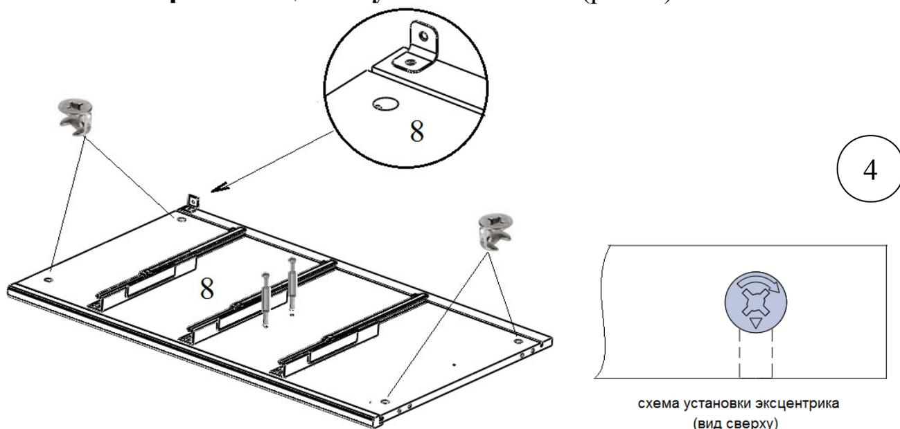
В детали №8 и №9 в отверстия Ø15мм вставьте эксцентрики, в отверстия Ø8мм вставьте шканты и в отверстия Ø5мм вкрутите штоки эксцентрика (рис 4), закрепите уголок саморезами 3,5x16 как показано на рис 4.
