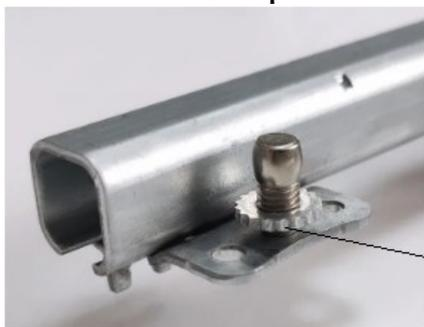
гайка для регулировки
