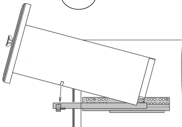
Вставьте ящики. Для этого выдвиньте направляющие вперёд, вставьте ящик так, чтобы крючок направляющей попал в отверстие задней стенки ящика, опустите ящик вниз, штырь направляющей должен попасть в отверстие боковой стенки ящика (рис.19).
