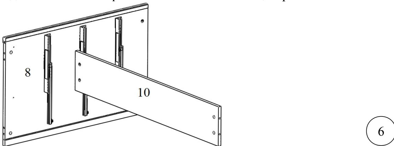
Соедините детали №10 и №8 (рис. 6). В детали №10 заверните эксцентрик до упора.
