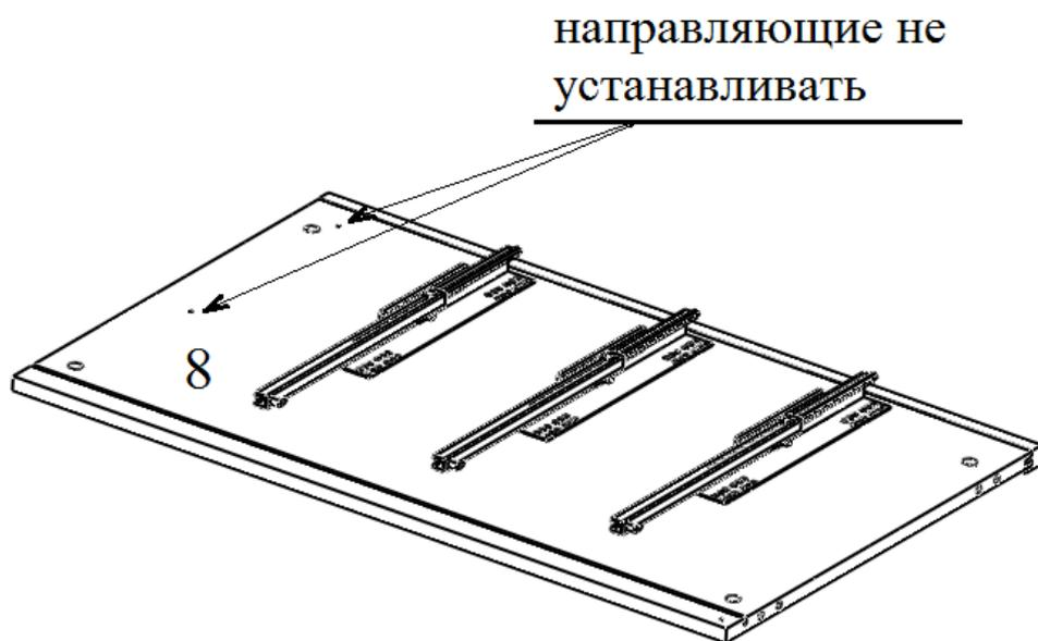
На детали №8 и №9 установите направляющие через отверстия, указанные на рис. 2, саморезами 3,5x16 по наколам. **На нижнюю пару наколок направляющие не устанавливаются** (рис. 3)!
