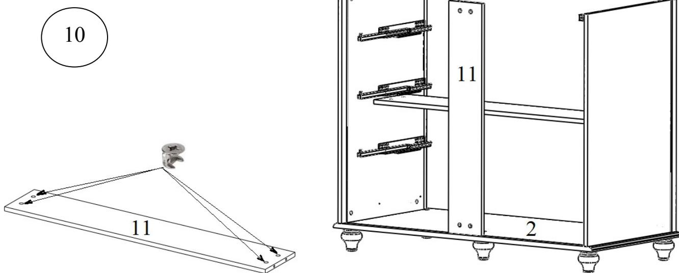
В деталь №11 в отверстия Ø15мм вставьте эксцентрики. Установите деталь №11 на подсобранный конструкцию. В детали №11 заверните эксцентрики до упора.
