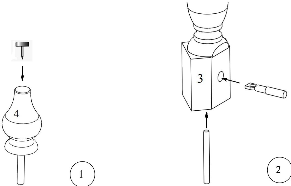
Вбейте в ножки №4 опора-гвоздь (рис.1). Вставьте шпильку в боковое отверстие ноги №3. В нижнее отверстие ноги №3 вставьте штифт так, чтобы он попал в отверстие в шпильке (рис.2).
