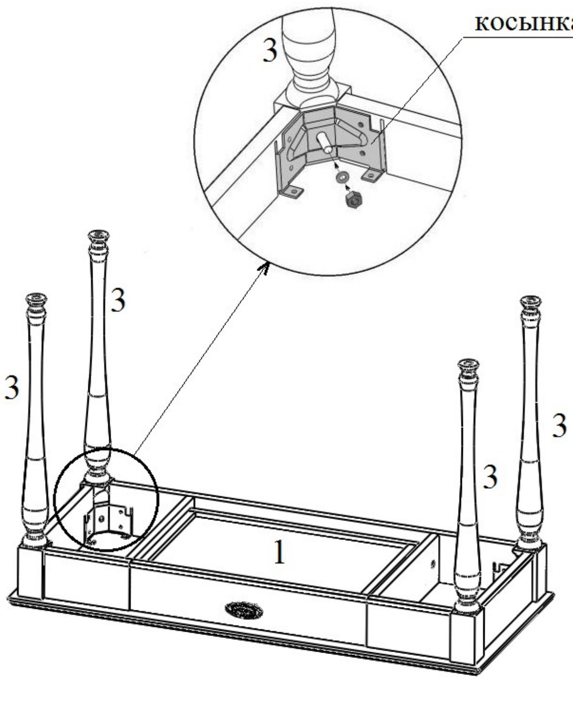
Придерживая штифт, установите ноги №3 на деталь №1, так чтобы шпилька вошла в отверстие косынки (рис.3). Наденьте шайбу на шпильку и заверните гайку до упора (рис.3).
